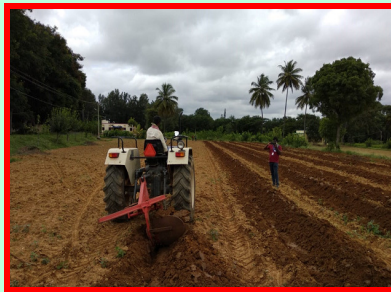
फफूदीबोर्ड हल का उपयोग करते हुए भूमि की तैयारी Land preparation using mould board plough
